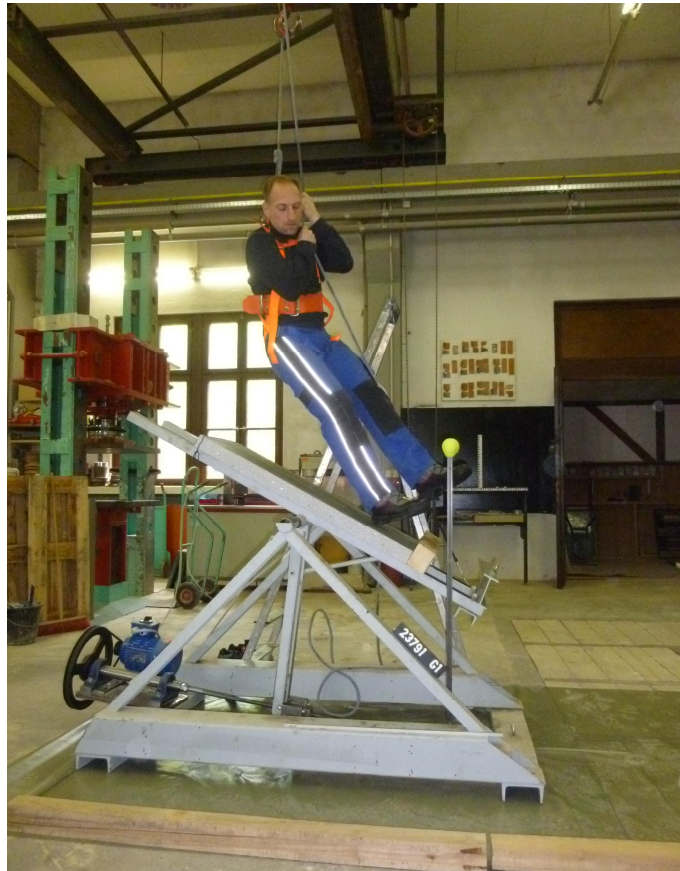
Abb. 1: Betonplatte mit unbehandelter Oberfläche „Bezeichnung Gi.Gi 1“ im Prüfzustand „trocken“ zum Zeitpunkt des Ausrutschens d.h. beim Erreichen des Akzeptanzwinkels.
