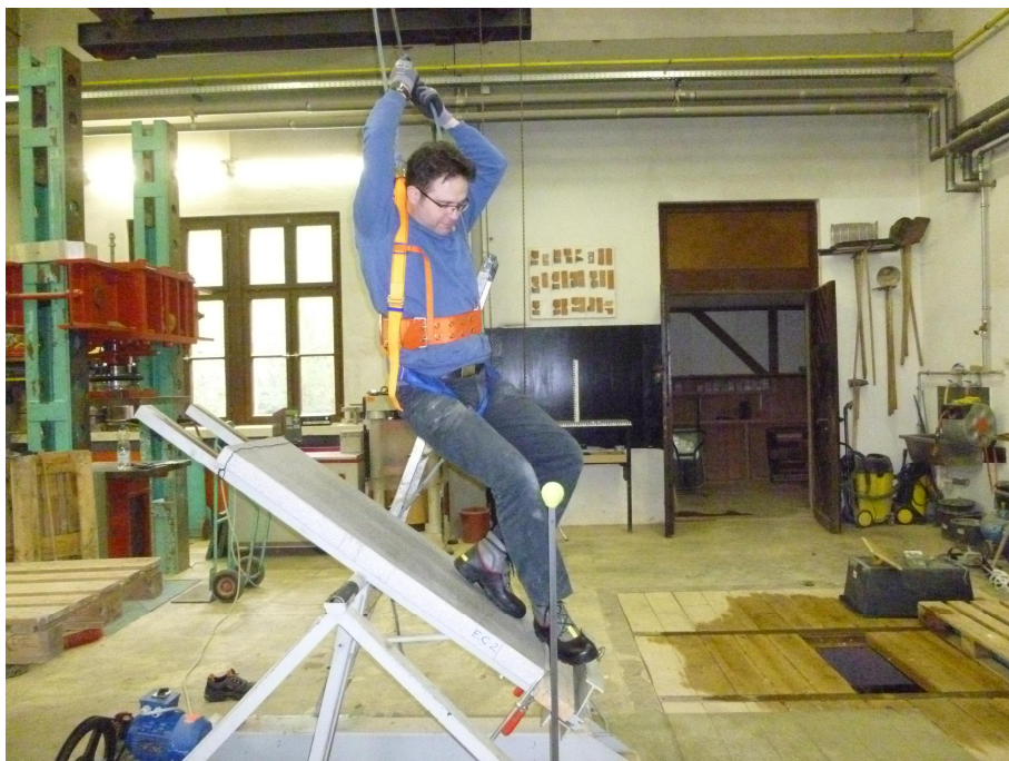
Abb. 4: Betonplatte mit unbehandelter Oberfläche „Bezeichnung EverCrete 2“ im Prü fzustand „trocken“ zum Zeitpunkt des Ausrutschens d.h. beim Erreichen des Akzeptanzwinkels.
