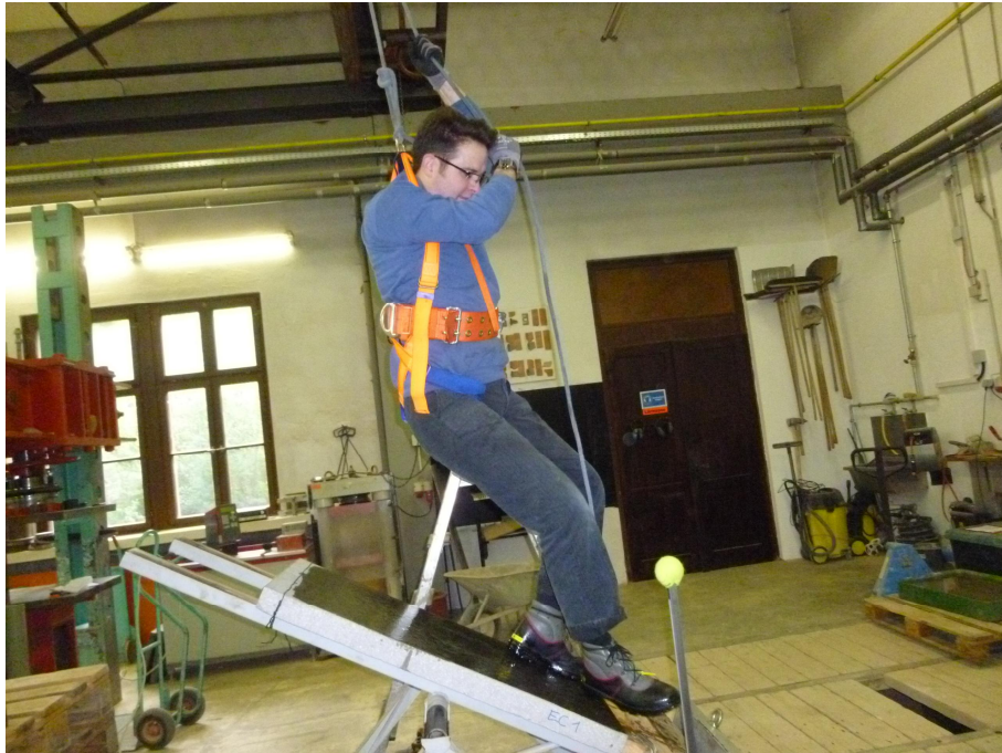
Abb. 3: Betonplatte mit unbehandelter Oberfläche „Bezeichnung EverCrete 1“ im Prü fzustand „ölig“ zum Zeitpunkt des Ausrutschens d.h. beim Erreichen des Akzeptanzwinkels.
