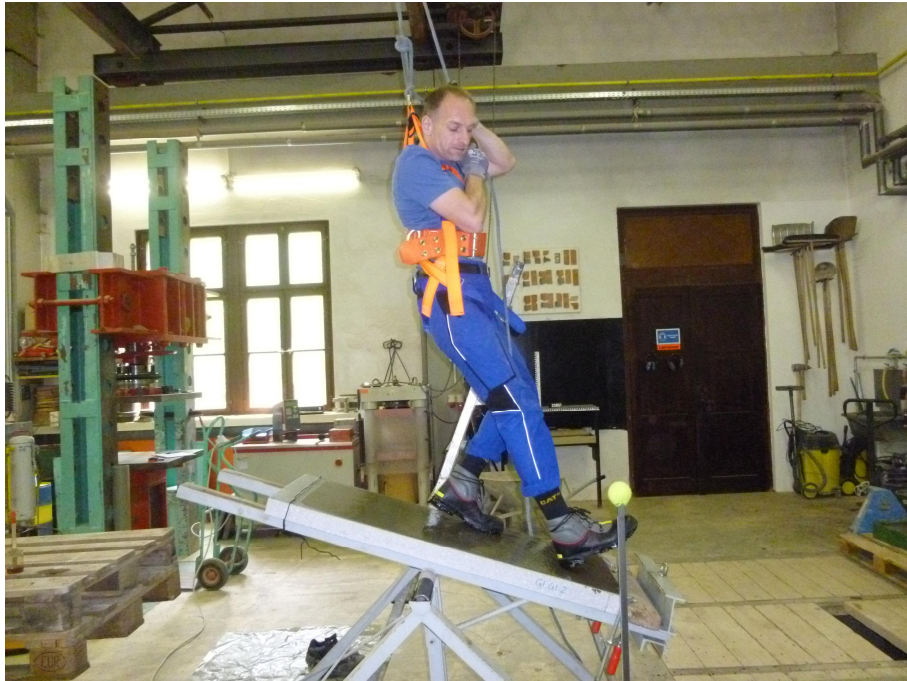
Abb. 5: Betonplatte mit unbehandelter Oberfläche „Bezeichnung Gi.Gi 2“ im Prüfzustand „ölig“ zum Zeitpunkt des Ausrutschens d.h. beim Erreichen des Akzeptanzwinkels.
