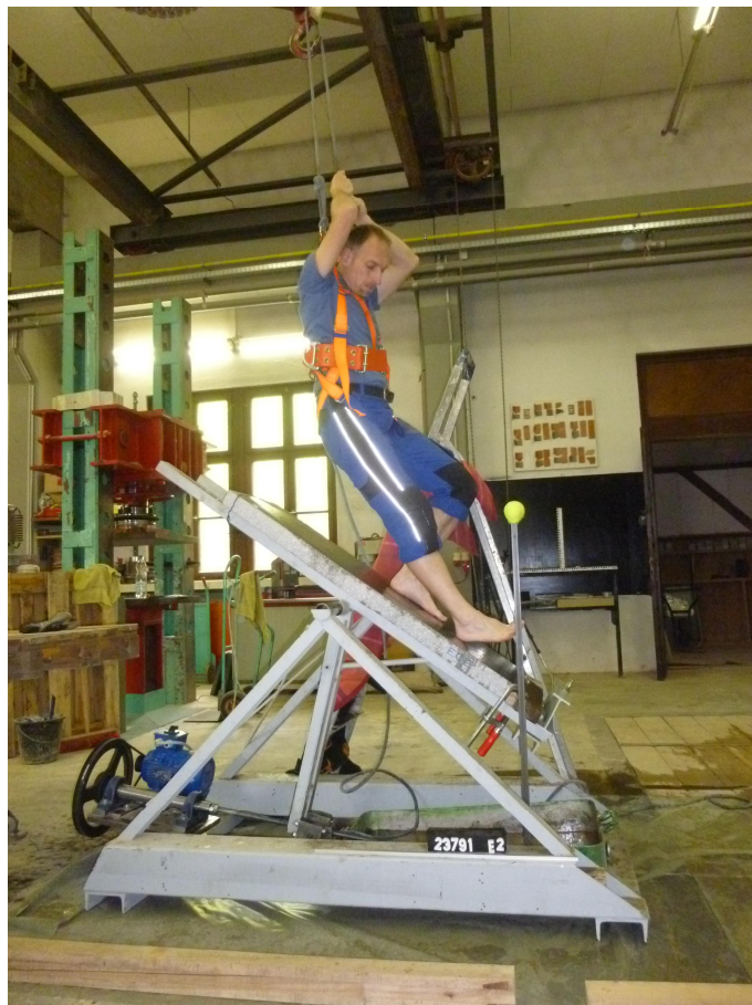
Abb. 6: Betonplatte mit unbehandelter Oberfläche „Bezeichnung EverCrete 2“ im Prüfzustand „nass“ zum Zeitpunkt des Ausrutschens d.h. beim Erreichen des Akzeptanzwinkels.
