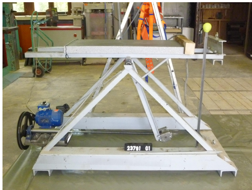
Abb. 1: Prüfanordnung des Begehungsverfahrens „Schiefe Ebene“ zur Messung der Rutschhemmung nach DIN 51130:2014-02. Im Bild vorne rechts ist die vertikale Ableseskala für die Berechnung der Neigung sowie im Hintergrund die Aufstiegshilfe und der angehängte Personen-Sicherheitsgurt ersichtlich.
